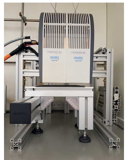
Bild 3. Der Matrixabtrag im Reparaturbereich erfolgt mithilfe eines UV-LED-Strahlers. Im Vergleich zu üblichen Verfahren entfällt der manuelle Aufwand, was für eine höhere Reproduzierbarkeit sorgt. © ITM
